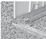
**Alu-Bodenrahmen** gibt auf unebenem Untergrund die notwendige Stabilität, falls Sie kein Betonfundament errichten wollen. Der Bausatz besteht aus Aluminium-Profilrohren (40 x 40 mm) mit Eckverbindungen und Befestigungsmaterial (Bodenanker sowie Schrauben).
