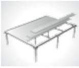
**Erdschrauben-Fundament** ideal zum Ausgleichen von Bodenunebenheiten und Hangneigungen, gesamtes Befestigungsmaterial und das Handeindrehwerkzeug zum Eindrehen der Erdschrauben inklusive (Zusätzlich benötigtes Werkzeug: Schlagbohrmaschine, Bohrer Ø 40 x 600 mm, Wasserwaage, Akku-Schrauber, Gabelschlüssel SW13 und SW24, Schaufel), max. Belastbarkeit von 200kg/m<sup>2</sup>
