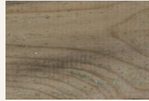
Umweltkeime, Stockflecken und leichter Schimmelbefall
