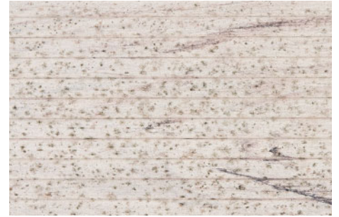
Stockflecken/Schimmel auf der Oberfläche
