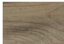
Umweltkeime, Stockflecken und leichter Schimmelbefall
