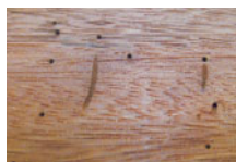
„Pinholes“ bei überseeischen Harthölzern
