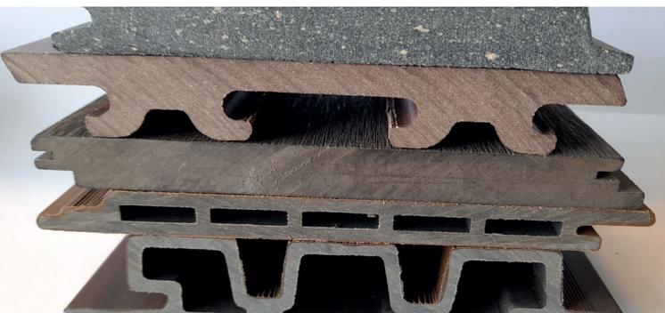
Fassadenprofile werden als Hohlkammer oder Vollprofil hergestellt.
