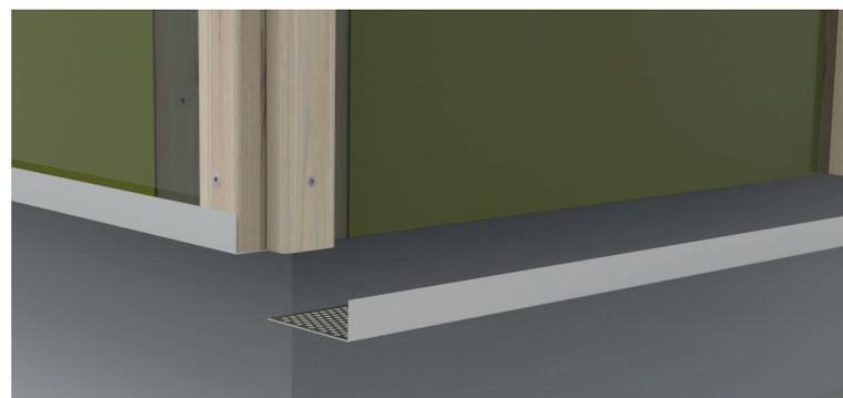
Bei hinterlüfteten und belüfteten geschlossenen Fassaden müssen geeignete Kleintierschutzgitter eingebaut werden, die die geforderten Be- und Entlüftungswerte ermöglichen.
