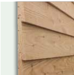
Fassadenprofil 28/15 x 142 mm, mit Nut und Feder, Sichtseite fein gesägt, technisch getrocknet
