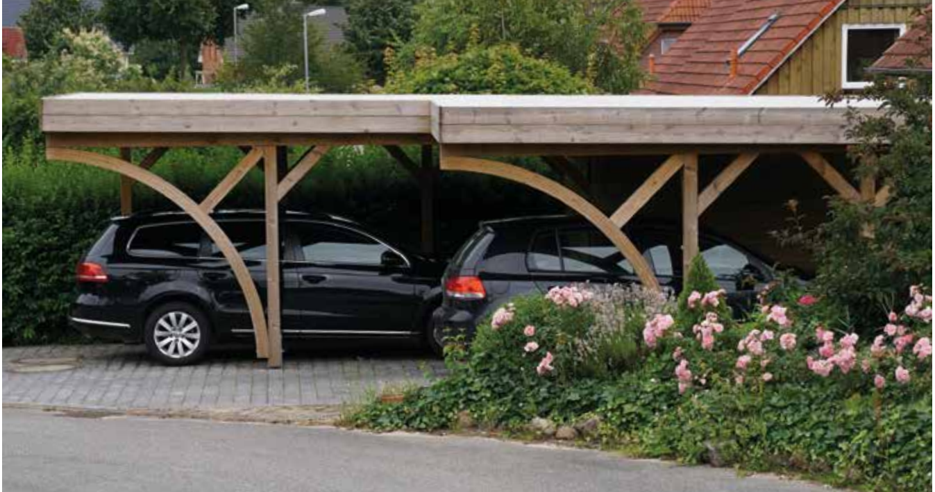
Als bewährte praktische Alternative zum herkömmlichen Pfosten bei engen Einfahrtsituationen. Pfostenbogen an einem Winkelcarport (Sondermodell). Inkl. verstärkter Konstruktion/geänderter Pfostenabstände. Lieferbar für Standard-Durchfahrtshöhe von 210 cm. Rechenbeispiel s. Tabelle rechts.
