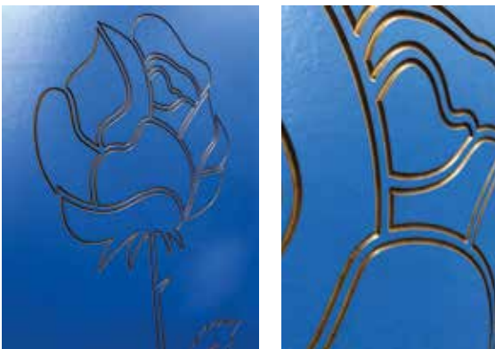
Beispiel einer Fräsung auf einer HPL-Platte
