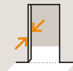
WST: Wandstärke einschließlich Putz, Kacheln etc.
