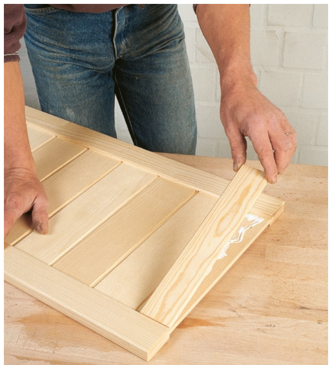
Möbelzuschneidetüren: Anleimen der Rahmenabschlussleiste
